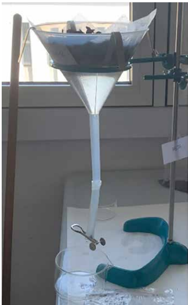
Figura 3 – Imbuto di Baermann utilizzato per l'estrazione di tardigradi dalla lettiera di foglie. L'imbuto è dotato di una griglia metallica su cui adagiare la lettiera. È possibile aggiungere un telo sintetico a maglie fini che solitamente si utilizza per proteggere le piante dal gelo per ridurre la caduta di sedimenti
